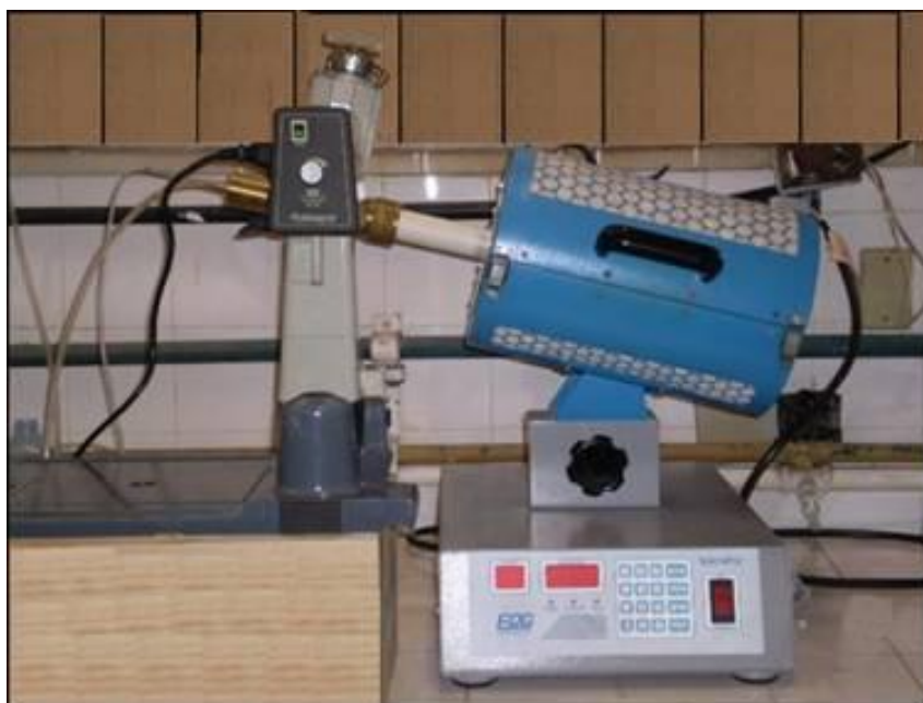
Figura 5.2 – Forno tubular bipartido com sistema rotativo e inclinação ajustável
