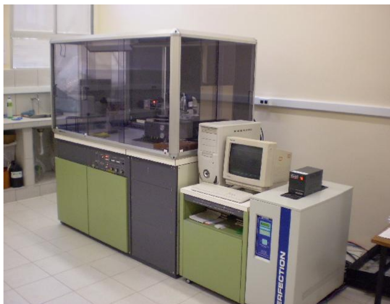
Figura 5.3 - Difratorômetro de raios-X (Rigaku - DMAXB).
