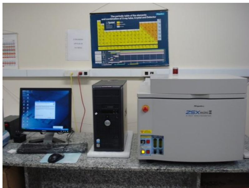
Figura 5.4 – Equipamento de Fluorescência de Raios-X (Rigaku - ZSX Mini II).
