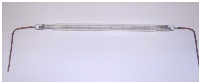
Figura 3.5 - Foto da lâmpada halógena com solda prata nos terminais.
