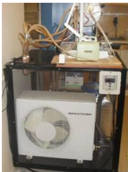
Figura 3.13 - Sistema de refrigeração do forno tubular (direita) e trocador de calor que encapsula os contatos das lâmpadas halógenas (esquerda)
