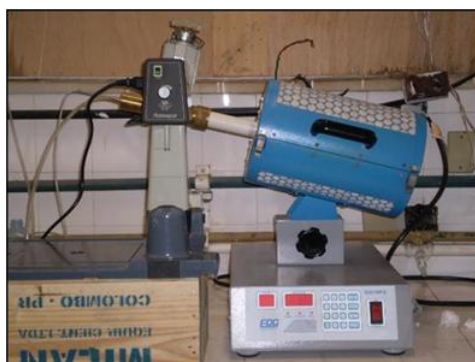
Figura 17: Forno tubular rotativo desenvolvido no laboratório de raios X.
