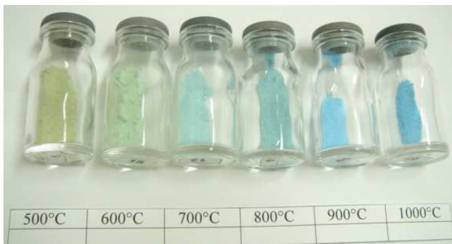
Figura 7.2: Coloração das amostras da série 1 nas temperaturas de calcinação.
