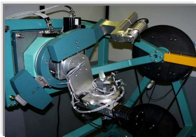
Figura 4.7 Difratômetro de raios-x, estação XRD1 no LNLS, Campinas-SP
