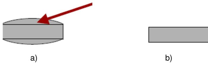
Figura 2.12 - a) Gases retidos na amostra após sinterização; b) Peça corretamente sinterizada. Fonte: [falves@fe.up.pt](mailto:falves@fe.up.pt), [www.fe.up.pt/~falves](http://www.fe.up.pt/~falves).
