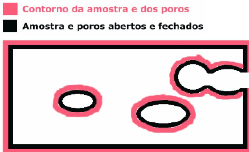
Figura 2.1 - Amostra contendo poros abertos e fechados (RICHERSON, 1992).
