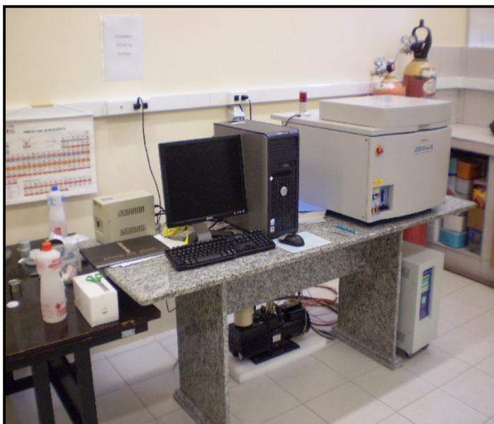
Figura 3.4 - Equipamento de Fluorescência de raios X/Rigaku (ZSX Mini II).
