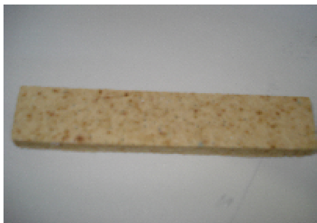
Figura 20 - Barra de material refratário sinterizada a 1500° C
