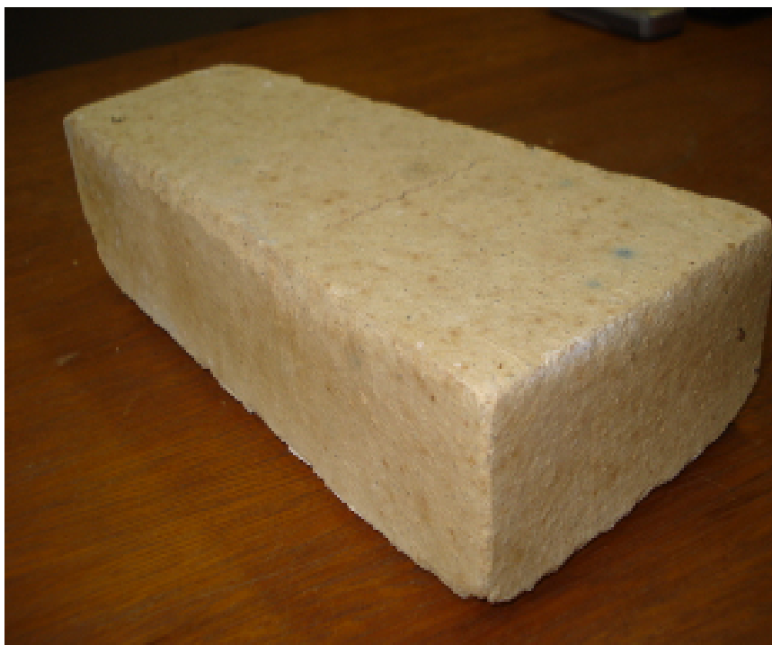
Figura 21 - Tijolo refratário (dimensões: 229x114x76mm)
