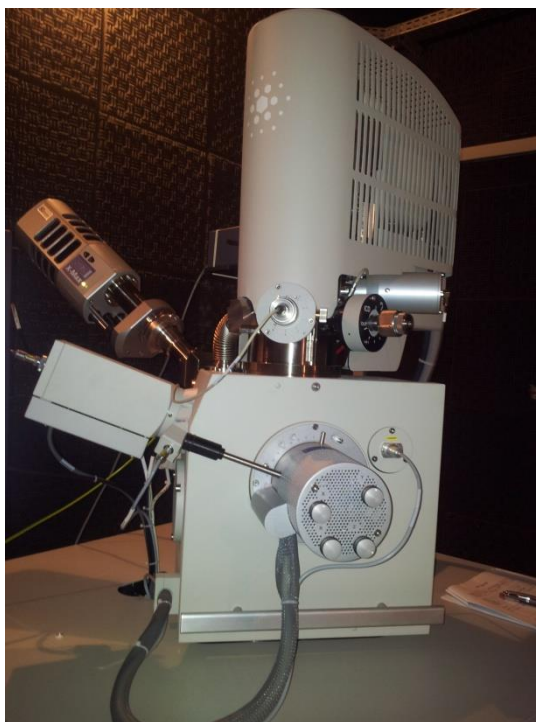
Figura 2. 4 - Microscópio FEI Inspect F50 – High Resolution SEM
