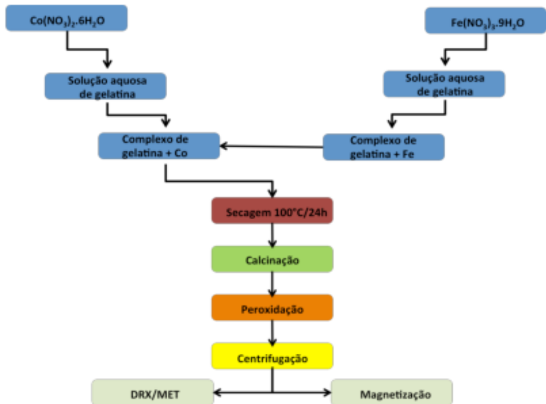
Figura 3.2 – Processo de síntese e caracterização de nanopartículas de \text{CoFe}_2\text{O}_4 .
